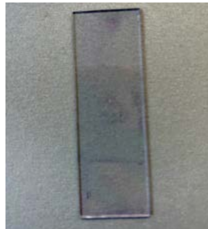
ABB. 11 Tinte/Edding-Beschriftung abgewaschen, keine Zuordnung möglich
